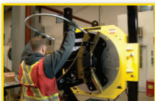
Remove hold down u-bolt.
